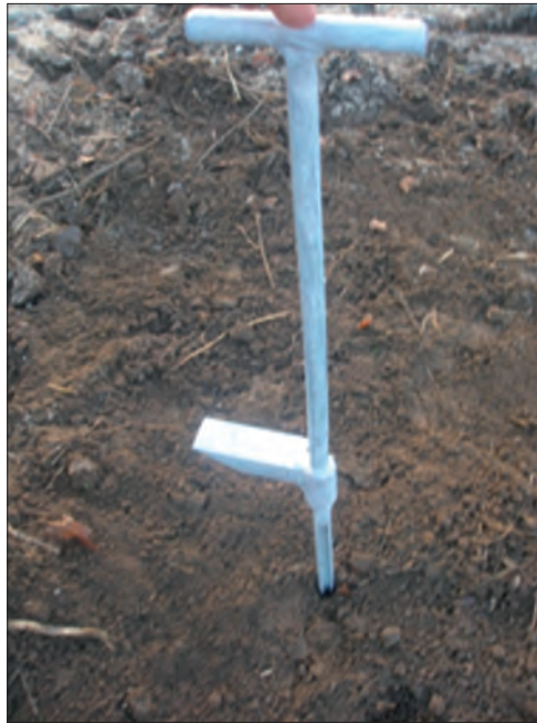
Рис. 3. Удосконалений бур для відбору зразків ґрунту
