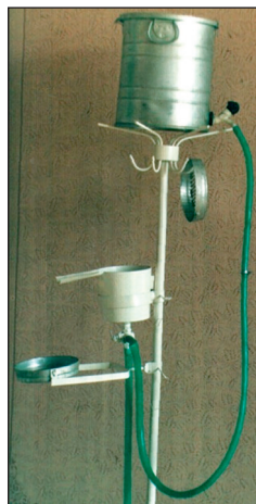
Рис. 1. Апарат «РУТА» для виділення цист картопляних нематод та зооспорангіїв збудника раку:
