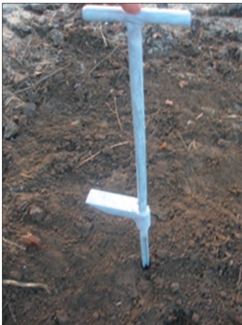
Рис. 3. Удосконалений бур для відбору зразків ґрунту
